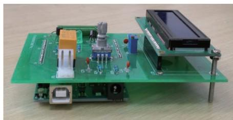
图 4 温度检测显示控制器全图
